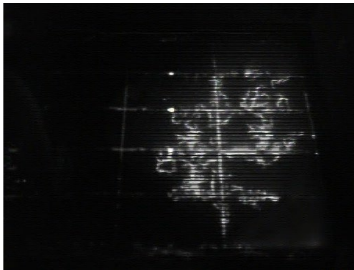
図 I . 8-1 順電位勾配での太陽電池パネルクーポン表面での放電のビデオ画像
