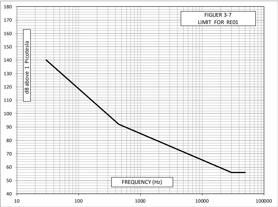
図 5-4 磁界放射雑音限界 (RE01) (MIL-STD-461C Figure 3-7 を元に再描画)
