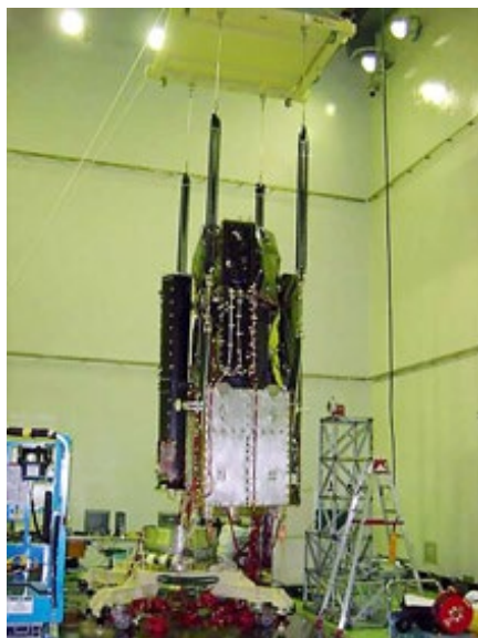
図 6. 7 試験コンフィグレーション (太陽観測衛星「ひので (SOLAR-B)」の例) [34][35]
