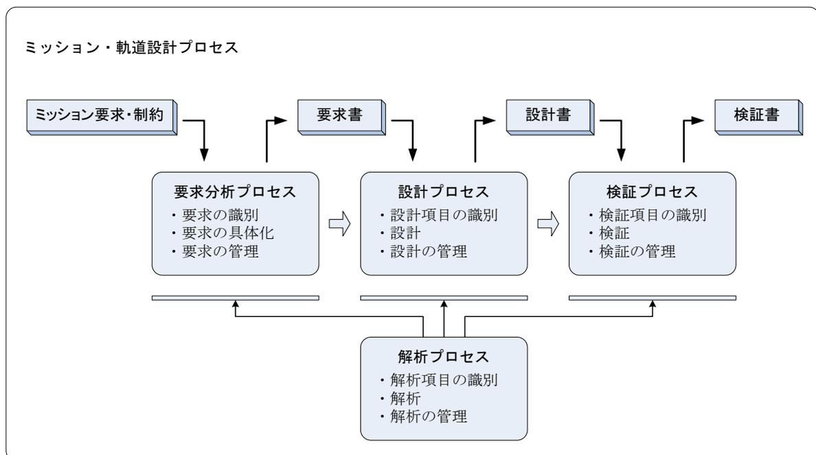
図 2-1 ミッション・軌道設計プロセス
