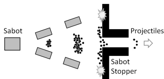
図 II- 26 散弾方式による模擬デブリの射出
