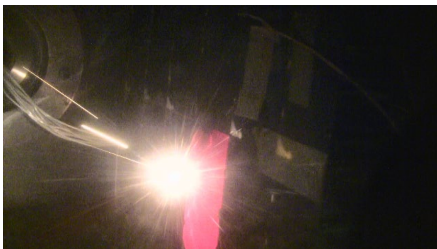
図 II- 9 3 接合太陽電池クーポンパネルへの衝突による持続放電
