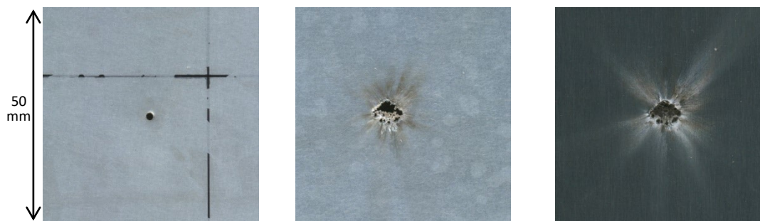
(a) ハニカムパネル表面 (b) ハニカムパネル裏面 (c) A2024 板
