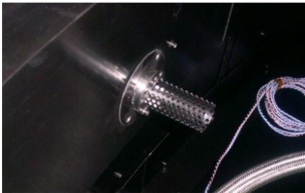
図 G.3-3 放電防止用電離真空計カバー
