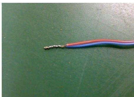
図 G.1-1 熱電対 (T型) の例
