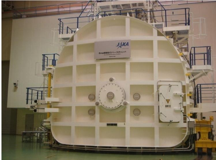
図 E.2-2 6mφ 放射計スペースチャンバの外観
