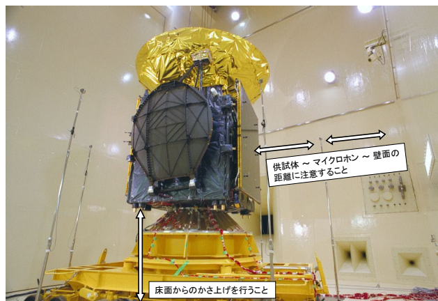
図 4-3 反響室床面に供試体を固定した試験
