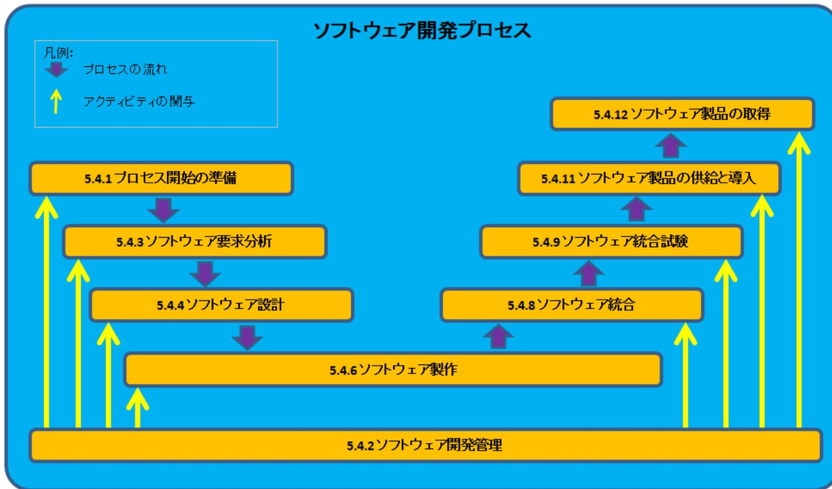
図 5.4.1 ソフトウェア開発プロセス全体構成の例
