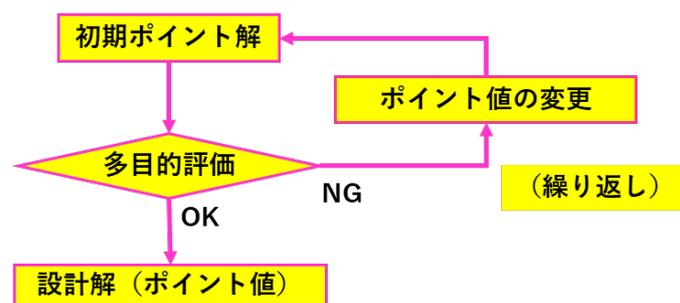
図 6.2-5 多目的性能の実現のためのポイント値評価の繰り返し
