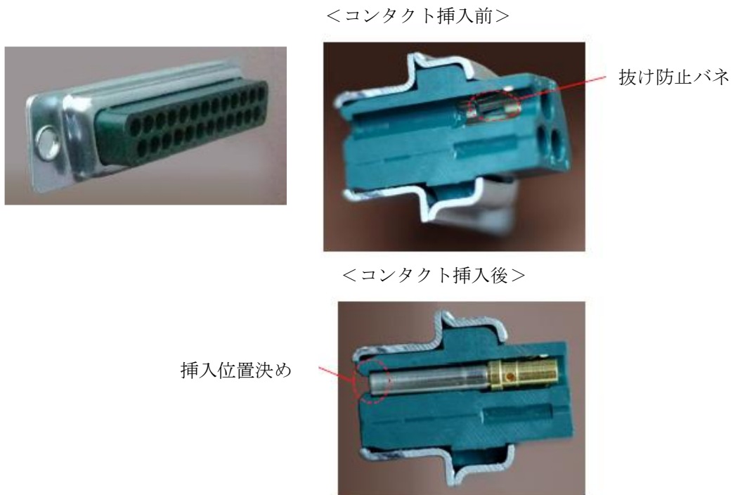
図 5-39 コネクタ内部にロック機構のある例
