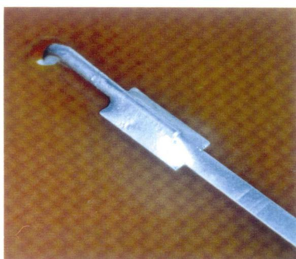
図 II - 6 プリント配線板への丸型リード線のオフセット沿わせ実装
