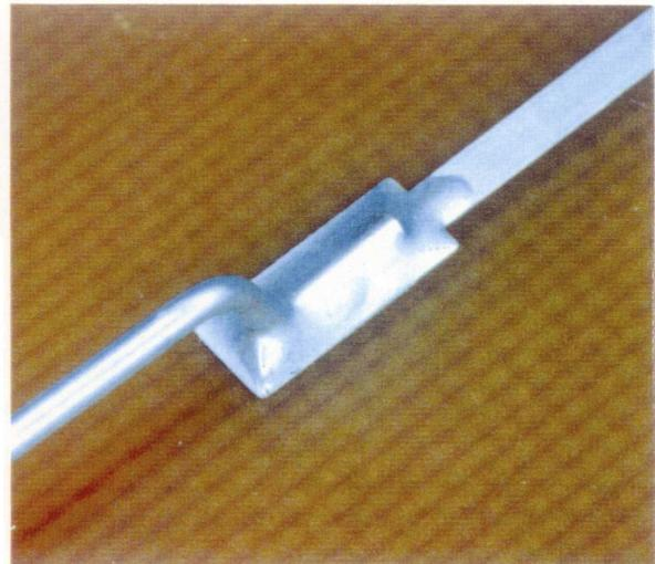
図 II- 4 プリント配線板への丸型リード線の表面沿わせ実装
