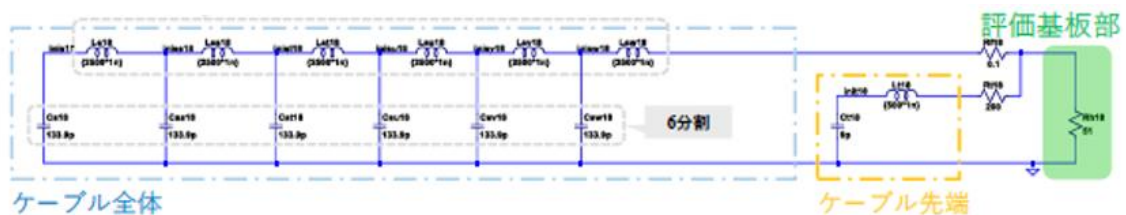
付図5-1 ハーネス起因ESDモデル（20mのXETFEハーネスの例）
