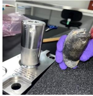
図3.3-1 米国フロリダ州で発見された破片（右）とそのオリジナル形状（左）（参考文書(14)）
