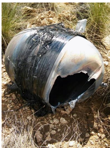
図3.3-3 2015年11月にスペインで発見された複合材圧力容器（COPV）（出展：参考文書(6)）
